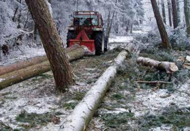
Seilwinden sind aus der Waldarbeit kaum mehr wegzudenken. Sie machen die Arbeit leichter und - bei ordnungsgemäßem Einsatz - auch sicherer. Mit Seilwinden können beim Fällen hängen gebliebene Bäume sicher zu Fall gebracht und die gefällten Stämme sowie das Kronenholz kräftesparend und bodenschonend aus dem Bestand gezogen werden.
