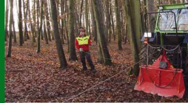
Die Winde darf nur von einem sicheren Standplatz aus bedient werden, so dass der Windenführer nicht gefährdet wird. Als sicher gilt der Führerstand des Rückefahrzeugs oder ein Standplatz in ausreichendem **Sicherheitsabstand** (mindestens 5 Meter) vom Rückefahrzeug. Unbedingt mit der Bergstütze (Schild) gegen Wegrutschen sichern!
