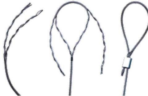
Werden Schäden am Seil festgestellt, ist es auszuwechseln oder zu kürzen. Ist die Seilendverbindung verschlissen, muss die Verbindung **fachgerecht als DIN-Verpressung oder Flämisches Auge** (Abbildung oben) erstellt werden. Auf das richtige Zubehör, wie Umlenrolle und Rundschnelle sowie Schäkel und Ketten, achten. **Jedes Zubehörteil** muss auf die **doppelte Windenzugkraft** ausgelegt sein (siehe Typenschild bzw. Etikett).
