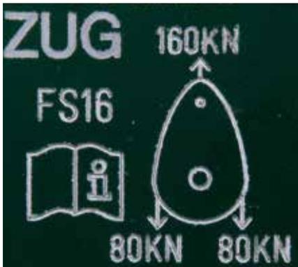
Angabe zur Arbeitslast auf dem Typenschild einer Umlenkrolle für eine Forstseilwinde mit 8 Tonnen Zugkraft.
