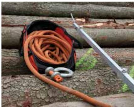
Arbeitsmittel für Anschlaghöhen bis 6 Meter: Teleskopgestänge mit Anschlagkralle, Baumzugseil (hier ummanteltes Kunststoffseil) mit Transportsack und Schäkel
