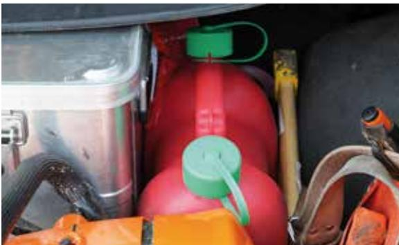
Beim Transport Einfüllstutzen demontieren
