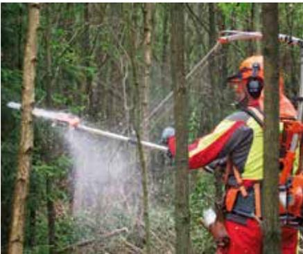
*Der sogenannte Spacer ist ein rückentragbarer, ergonomisch bedienbarer Forstfreischneider mit Schneidgarnitur. Die Schneidgarnitur ist an einer Galgenkonstruktion zur Gewichtsentlastung befestigt. Eine Bedienung mit geringster Tragebelastung ist damit möglich, was der ergonomischen und sicheren Steuerung des Arbeitsmittels zugutekommt.*
