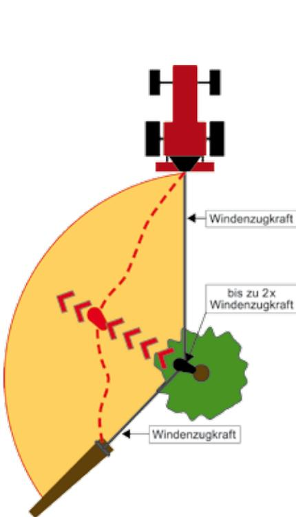
*Gefahrenbereich und Windenzugkräfte bei einfach umgelenktem Zug.*
