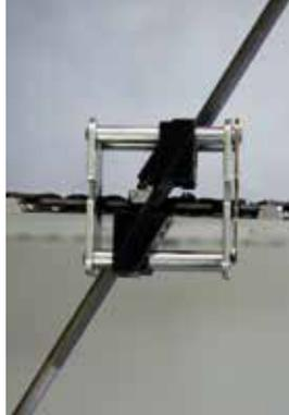
*Feilhilfen, wie ein Rollenfeilgerät, ermöglichen eine exaktere Feilenführung.*
