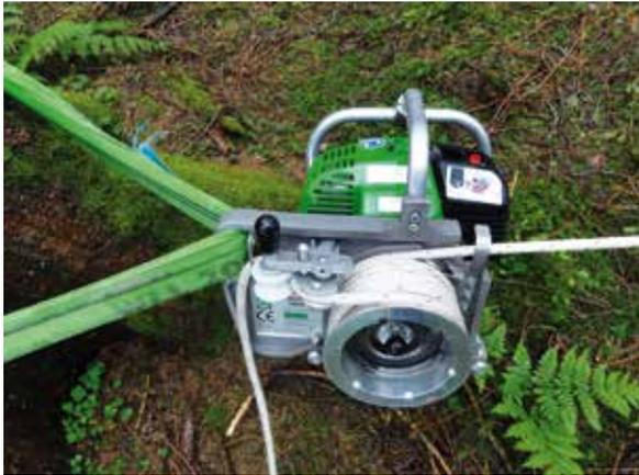
*Im Zugkraftbereich bis 1,8 Tonnen kann die Spillseilwinde die motormanuelle Arbeit leichter und sicherer machen*
