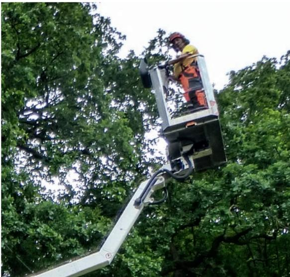
Beim Kauf oder Mieten von Hubarbeitsbühnen ist darauf zu achten, dass eine Bedienungsanleitung mit Konformitätserklärung und ein Prüfbuch mitgeliefert werden.
