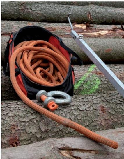
Arbeitsmittel für Anschlaghöhen bis 6 Meter: Teleskopgestänge mit Anschlagkralle, Baumzugseil (hier ummanteltes Kunststoffseil) mit Transportsack und Schäkkel
