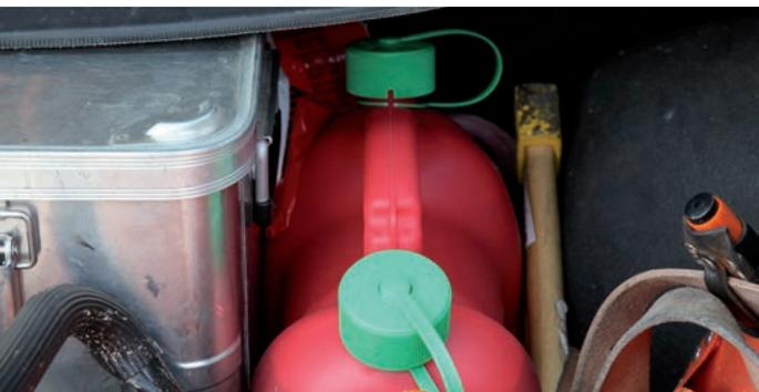
Beim Transport Einfüllstutzen demontieren
