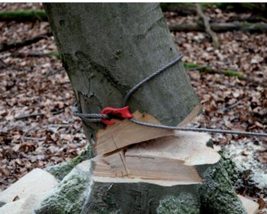
Abziehen mit der Forstseilwinde
