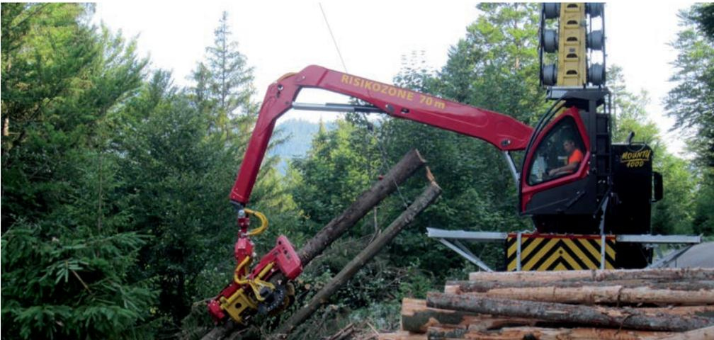
*Gebirgscharvester: Auf einem LKW integriertes Seilgerät.
