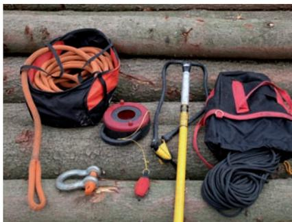
Arbeitsmittel für Anschlaghöhen über 6 Meter (bis ca. 15 Meter): Wurfbeutel, Wurfseil mit Aus-/Aufspulhilfe, Nachziehleine, Wurfbeutel schleuder (Big Shot), Baumzugseil, hier ummanteltes Kunststoffseil, Schäkkel, Transportsäcke
