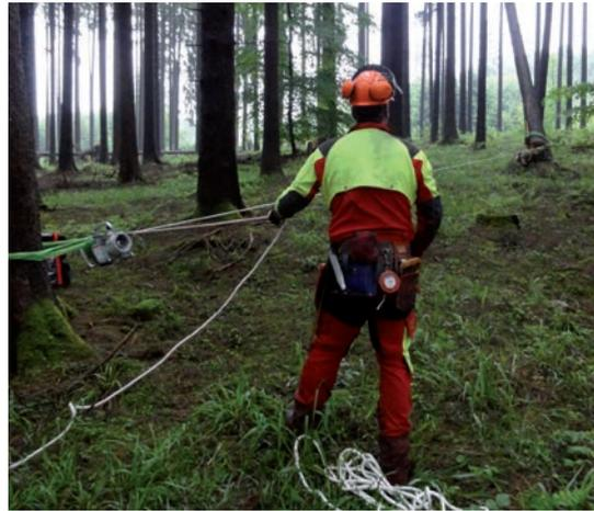
*Abziehen mit der Spillwinde*
