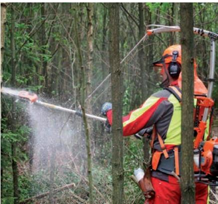
*Der sogenannte Spacer ist ein rückentragbarer, ergonomisch bedienbarer Forstfreischneider mit Schneidgarnitur. Die Schneidgarnitur ist an einer Galgenkonstruktion zur Gewichtsentlastung befestigt. Eine Bedienung mit geringster Tragebelastung ist damit möglich, was der ergonomischen und sicheren Steuerung des Arbeitsmittels zugutekommt.*
