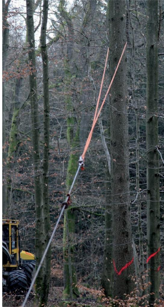
*Seilschäden durch zu großen Umlenkwinkel ( $>15^\circ$ ) am Schäkel können beim Einbau des Seils als Würgeschlinge drohen. Die Kunststoffseile sind möglichst als einfache Rundschlinge – offene U-Schlinge – in den Baum einzubauen.*
