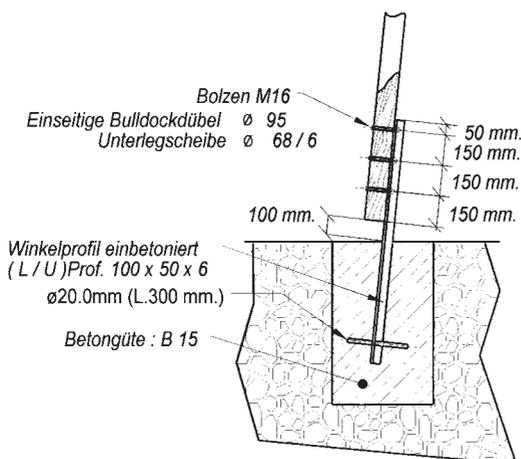
Zum Verfüllen des Aushubs keinen humushaltigen Boden sondern nur grobkörnigen Sand verwenden und diesen sorgfältig verdichten.
