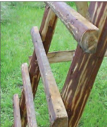
Oft werden Halbrundsprossen (Halblinge) verwendet. Die auf der Kreissäge aufgetrennten Stangen haben dann als Sprossen nur eine schmale Auftrittsfläche, von der man sehr leicht abrutschen kann. Es hat sich bewährt, diesen Grat mit der Kreissäge abzutrennen, so dass eine ca. 30 mm breite Auftrittsfläche entsteht.
