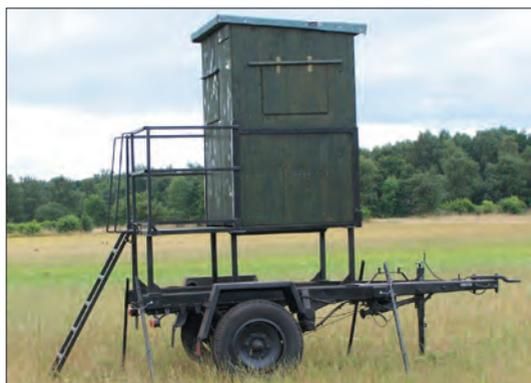
*Dieser mobile Hochsitz besitzt eine Betriebserlaubnis für die Teilnahme am öffentlichen Straßenverkehr. Beim Jagdeinsatz ist die Standsicherheit durch die ausgezogenen Stützen gegeben. Die klappbare Leiter mit rutschsicheren Sprossen gewährleistet einen sicheren Aufstieg.*
